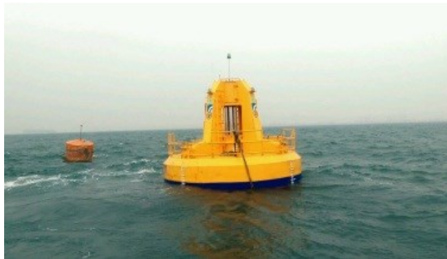
點吸收式波浪發電機系統 (工研院第二代, 2016)
