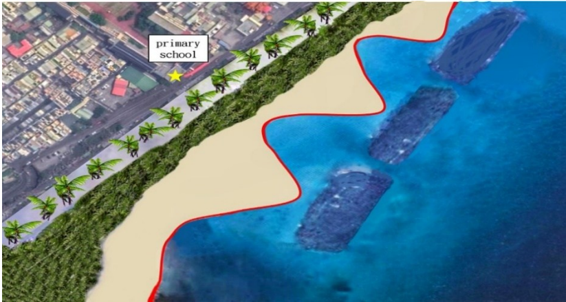
高雄蚵仔寮海岸潛堤、人工養灘及植被綜合性近自然工法
