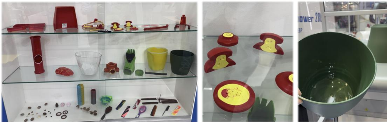
圖：現場使用PLASTIC METAL設備之共射出製程生產的雙組份產品
