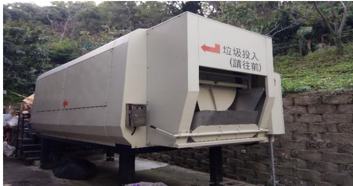
垃圾壓縮貯存設備
