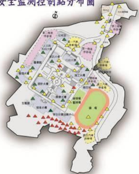
圖例說明 ▲ 一般監測點 ▲ 建築物安全監測 ▲ 建築物土壤沉降監測
